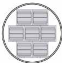
Für S1500-AB: Rack Konfiguration aus rostfreiem Edelstahl für 9.100 Vials
